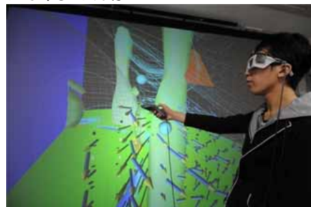
図 1 可視化した計算データをステレオ投影する。立体眼鏡をかけた研究者は高い没入感を持ってインタラクティブに流れを体験できる。
